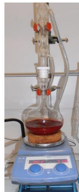
Montage de la synthèse après ajout de l'hydrazine
